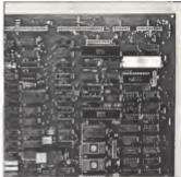
Un particolare della Big Board: i due drive sono il sistema. Si notano la EPROM del Kyberware, la Z 80 e le varie uscite disponibili.
